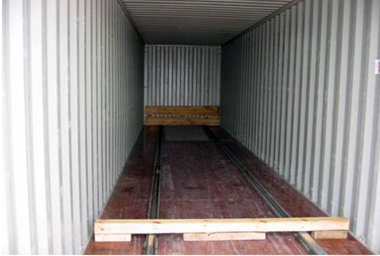
фото №1 - НАПРАВЛЯЮЩИЕ В КОНТЕЙНЕРЕ 40 ФУТ
